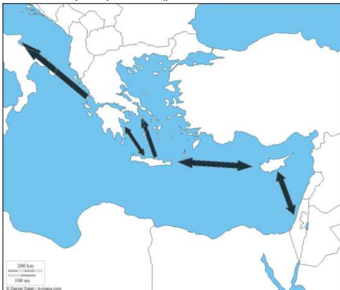
Σχήμα 6.3:Οι προτεινόμενες ηλεκτρικές διασυνδέσεις Ισραήλ – Κύπρου – Κρήτης με το Ευρωπαϊκό σύστημα “Eurasia Interconnector”
